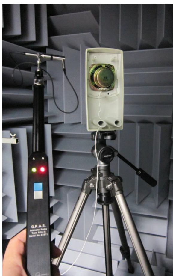
Obrázek 22: Ukázka z měření reproduktoru umístěného v otevřené ozvučnici. Sonda je ve stavu READY, po stisku modrého tlačítka by se spustilo měření.
