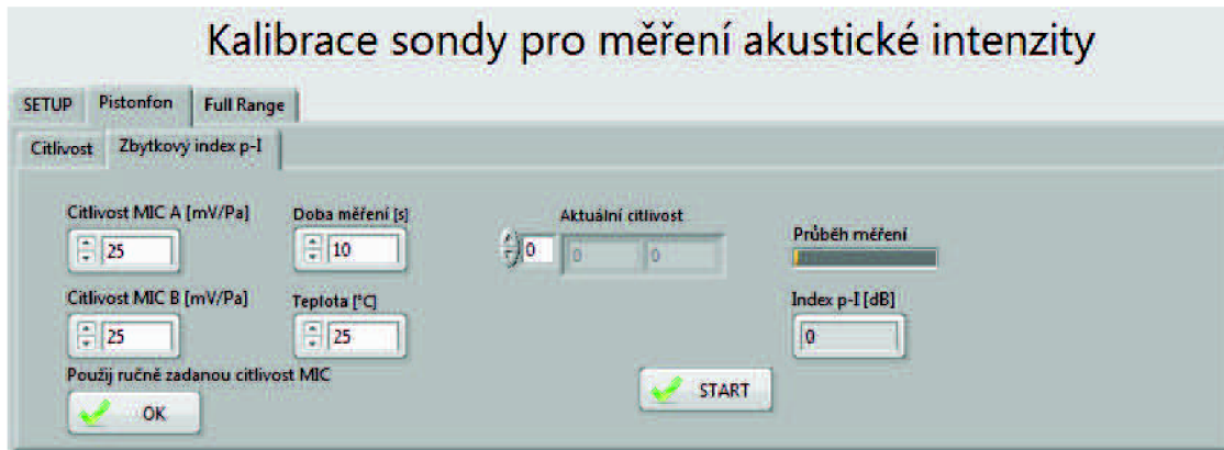
Obrázek 12: Aplikace pro kalibraci - zjištění \delta_{pI} pomocí pistonfonu
