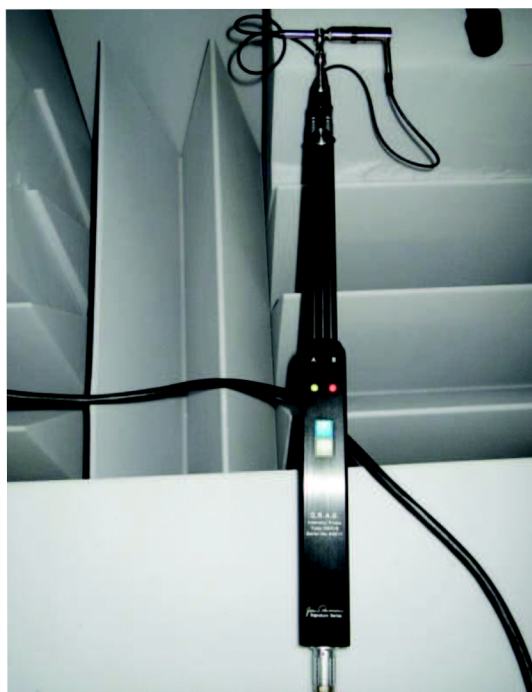
Obrázek 20: Intenzitní sonda G.R.A.S. 50AI - B s instalovanou distanční vložkou o velikosti 12mm
