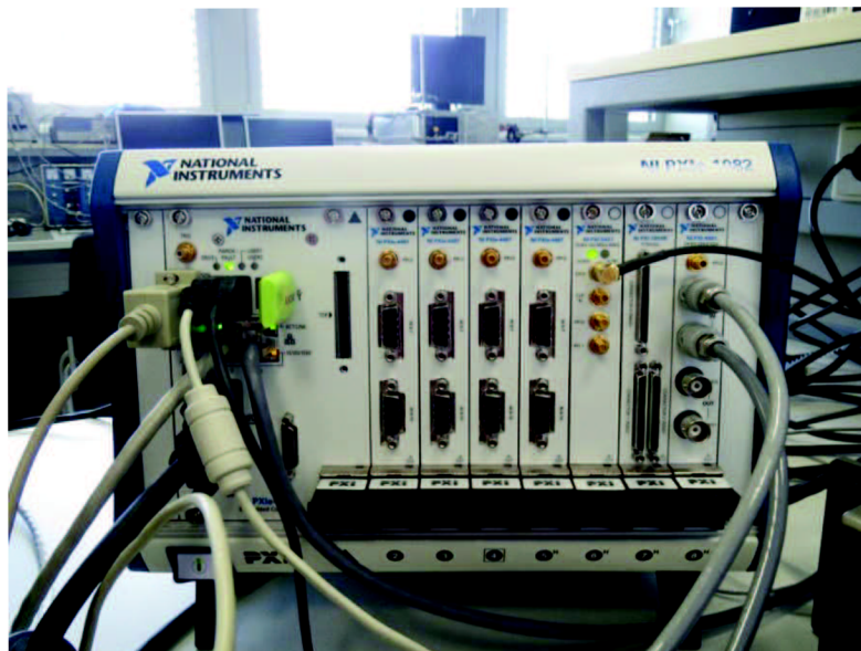
Obrázek 19: Měřicí zařízení NI PXIe 1082 s instalovanou měřicí kartou NI PXI 4461 (karta ve slotu č.8)
