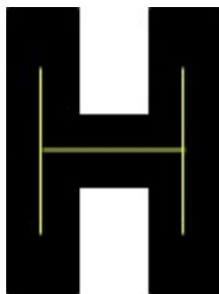
Obrázek 3.2: Příklad skeletonizace na písmenu H, kde linie označuje kostru.
