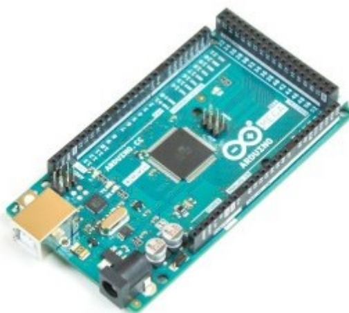
Obrázek 3.4: Arduino Mega 2560 Zdroj: https://store.arduino.cc
