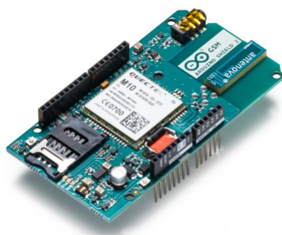
Obrázek 3.5: Arduino shield rozšiřující schopnosti Arduina.
