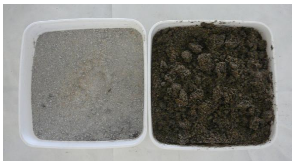
Obr. 6 Umělé půda před a po ovlhčení.
