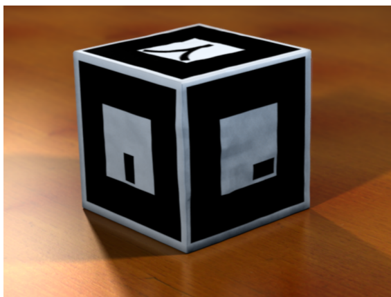
Obrázek 5.2: Fyzická kostka, která má na stranách nalepené značky ARToolKitu
