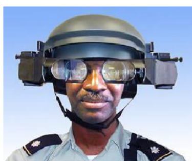
Obrázek 3.3: Video průhledové HMD [9]
