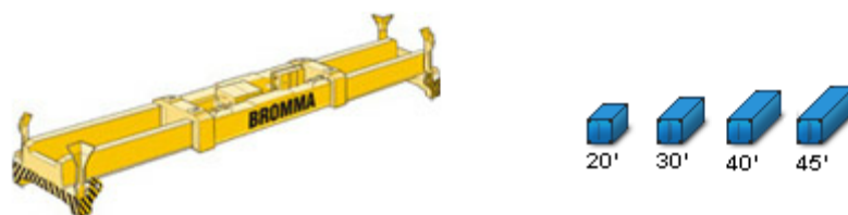
Obr. 30 Single lift spreader a velikosti zvedaných kontejnerů [17]
