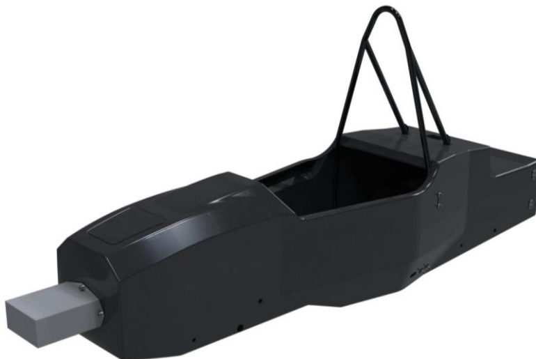
Obrázek 6: Monokok týmu FS Oxford tvořený uhlíkovým kompozitem [13]
