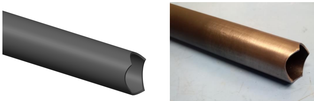
Obrázek 57: Porovnání modelu trubky se skutečným ořezem
