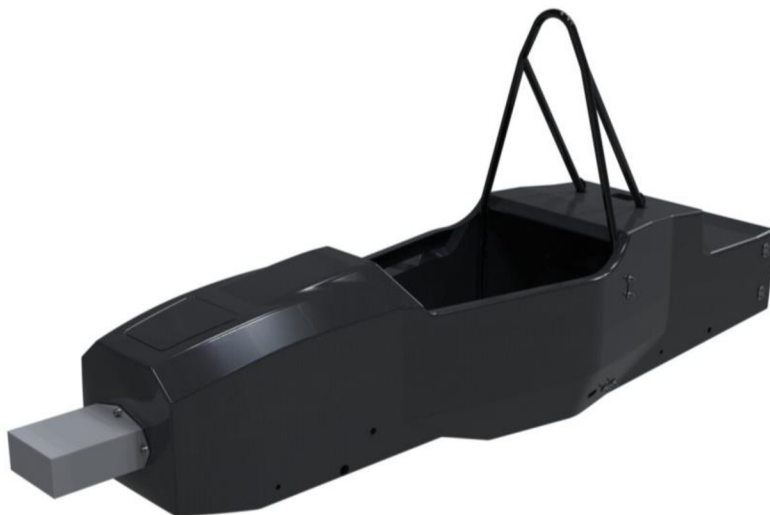
Obrázek 6: Monokok týmu FS Oxford tvořený uhlíkovým kompozitem [13]
