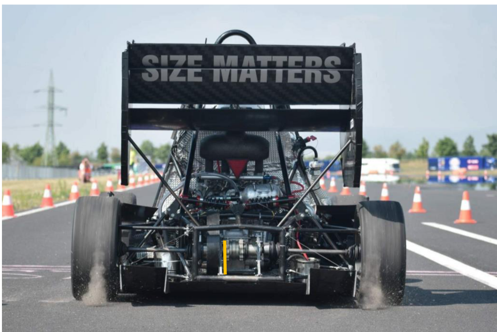
Obrázek 19: Fotografie z Mostu 2022 – již je patrné naklopení držáku diferenciálu
