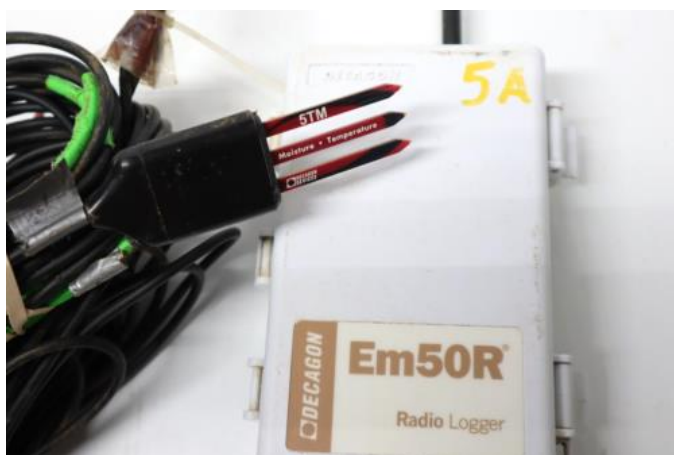
Obrázek č. 7: Dataloger EM50 s čidly pro měření vlhkosti půdy (autorka práce)
