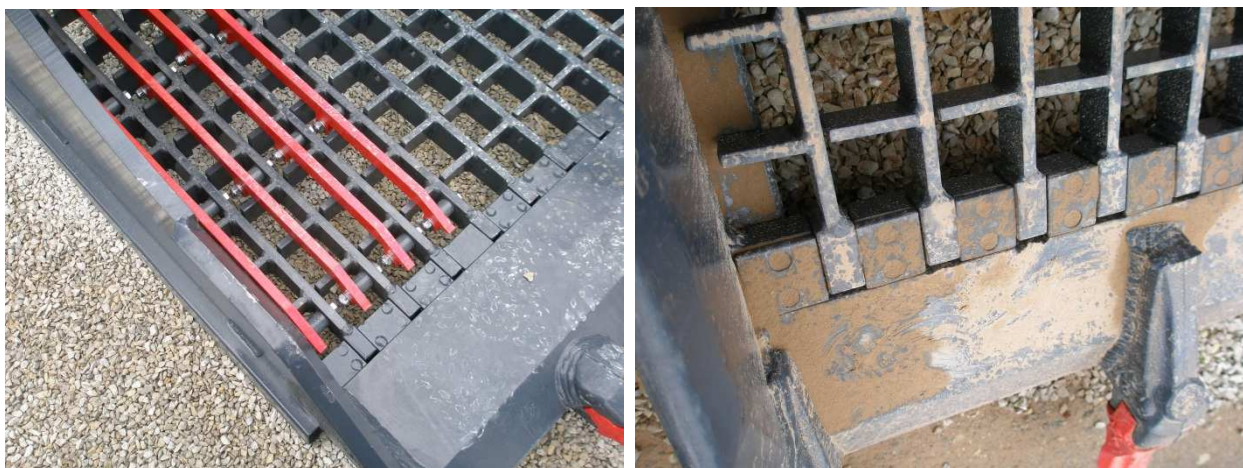
Obr. 6 Ukázka nastavovací lišty (vlevo) a uchycení roštu (vpravo). [vlastní foto]
