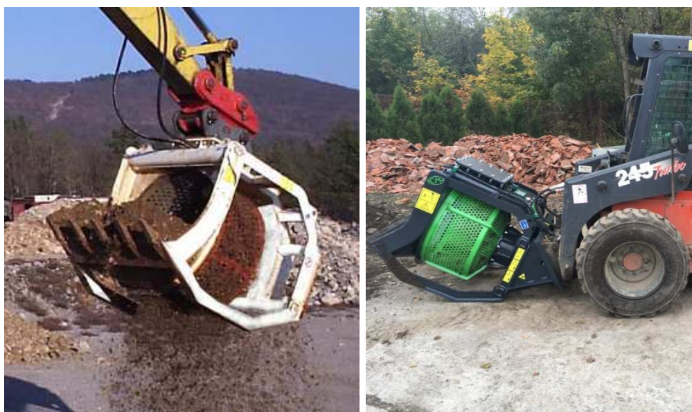
Obr. 14 Bubnová třídicí lopata přichycená upínací deskou z jedné strany. [10]
