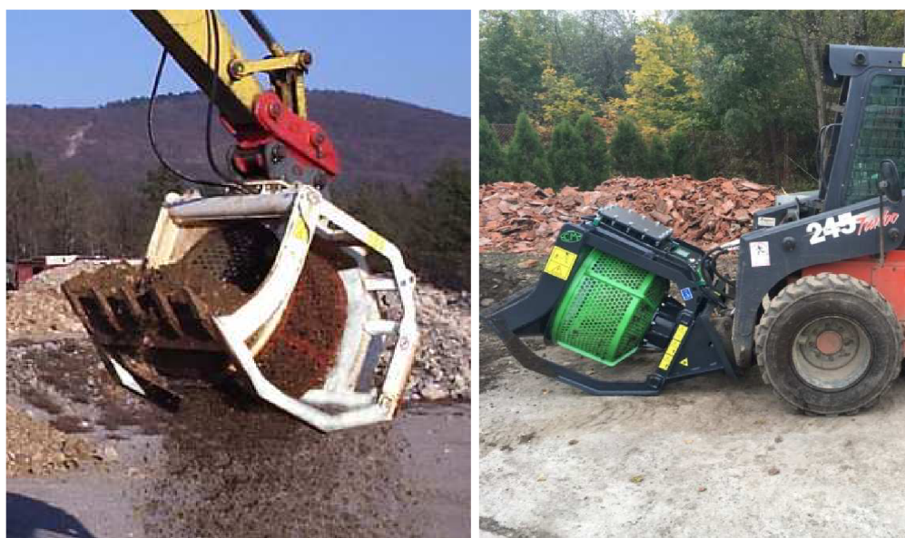
Obr. 14 Bubnová třídící lopata přichycená upínací deskou z jedné strany. [10]
