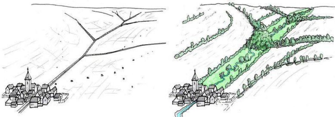
Obr. 12: Zatravnění údolnice a drah soustředěného odtoku (AOPK ČR, ©2007).
