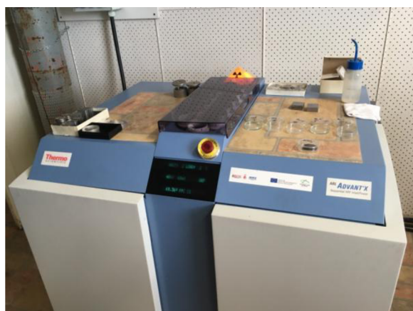
Obr. 14: Fluorescenční spektrometr řady ARL ADVANT'X [30]
