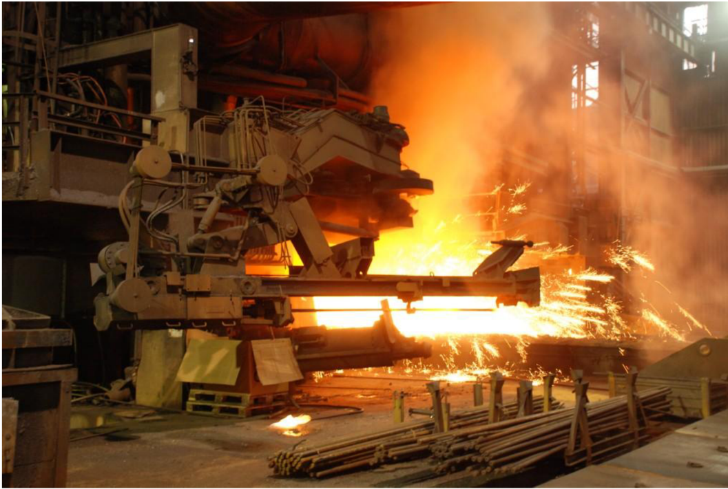
Obr. 1: Odpich tekutého surového železa z vysoké pece [2]
