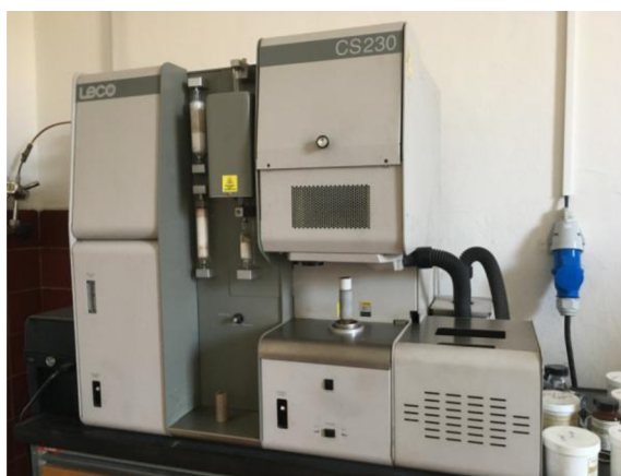
Obr. 15: Spalovací analyzátor uhlíku/síry LECO CS230
