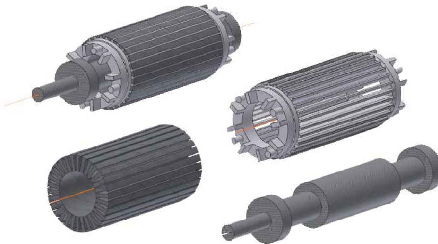
11.Obr. Sestavu rotoru nahoře vlevo komplet s použitou vazbou , dole rotorové plechy, vpravo nahoře výplň mezi plechy, dole hřídel rotoru.
