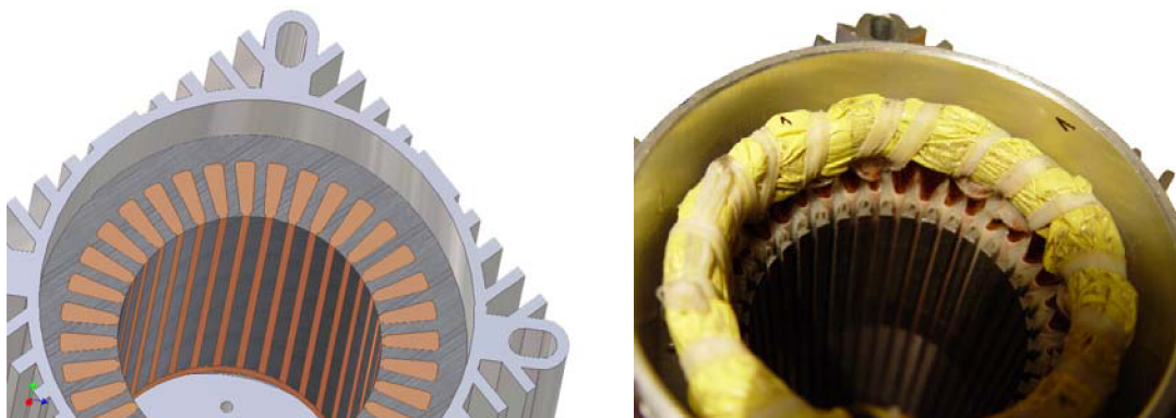
8.Obr. Část motoru našeho objektu vysunutí, vlevo kreslený a vpravo reálný “vinutí statoru“
