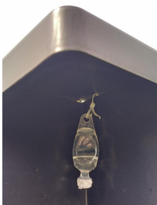
Obr. 15 - umístění feromonového odparníku s návnadou alfapinen:ethanol v poměru 1:3 na lapači Ecotrap®
