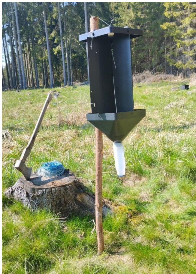
Obr. 14 – lapač Ecotrap® použitý pro odchyť kůrovců rodu Hylastes v Podkrkonoší v roce 2023
