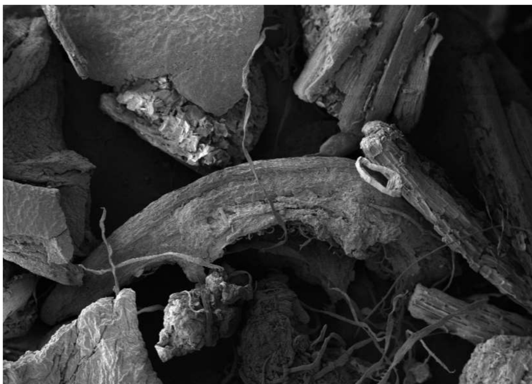
Obr. 6 Snímek SEM vzorku sáčkového čaje (zvětšeno 100krát)
