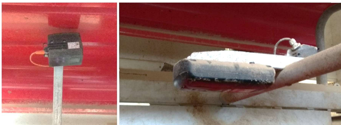
Obrázek 15 3D kamera (vlevo) a IR snímač (vpravo)
