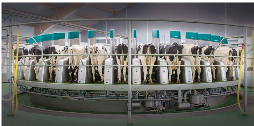
Obrázek 8 Robotizovaná dojírna DairyProQ
