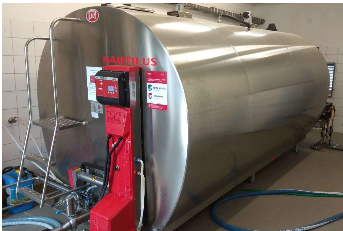
Obrázek 13 Mléčný tank Lely Nautilus o objemu 10 000 litrů
