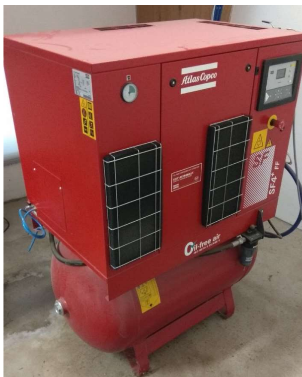
Obrázek 12 Kompresor Atlas Copco o výkonu 3,7 kW
