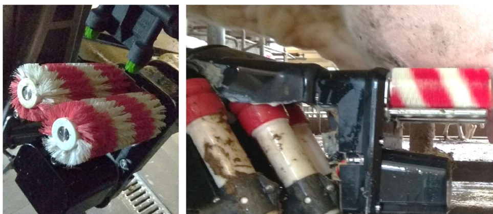
Obrázek 16 Protiběžné kartáčky (vlevo), čištění a stimulace struku (uprostřed), detekce struků TDS (vpravo)
