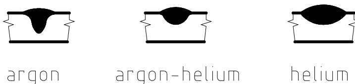
Obrázek 66 Rozdílnost závaru při použití ochranného plynu Ar a He, převzato a upraveno z [3]
