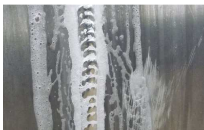
Obrázek 111 Zkouška tlakem-svár s vrstvou mýdlového roztoku, vlastní zdroj
