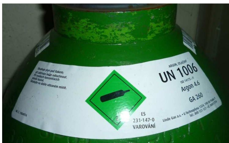
Obrázek 67 Označení lahve s ochranným plynem Ar, vlastní zdroj
