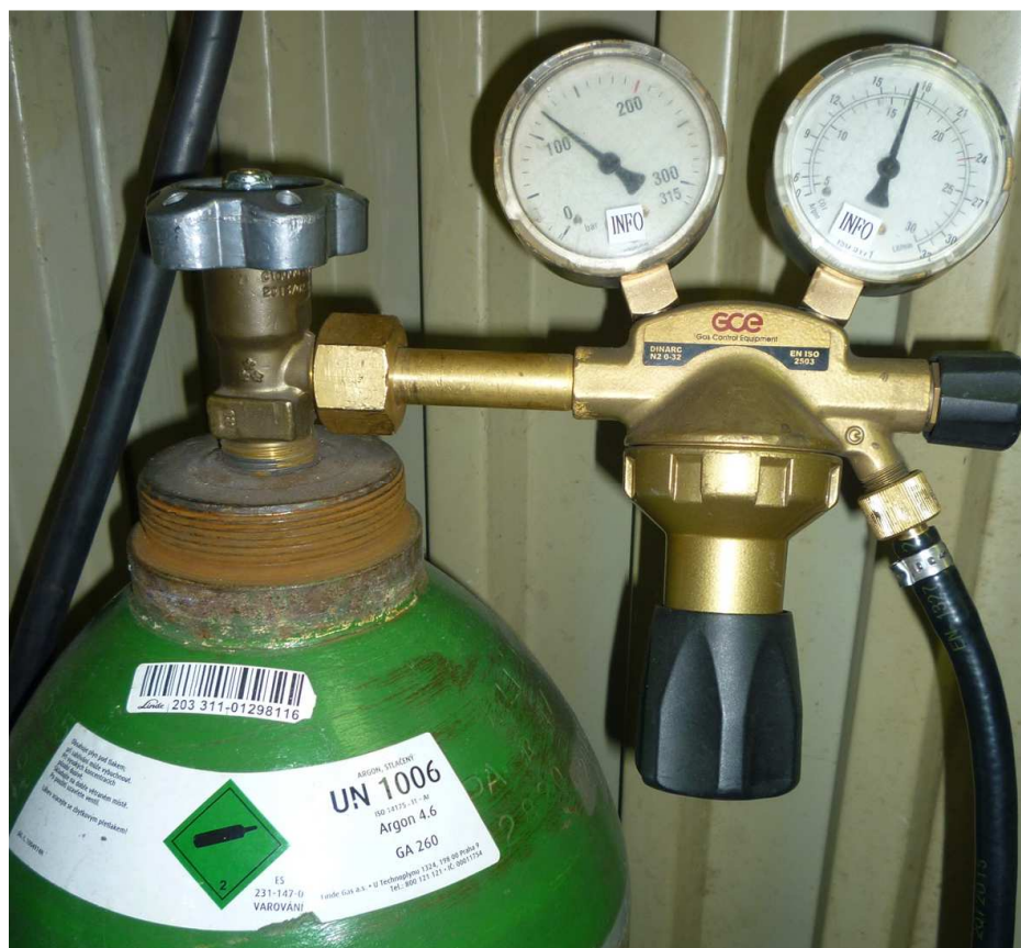
Obrázek 70 Lahvový a redukční ventil pro Ar, vlastní zdroj
