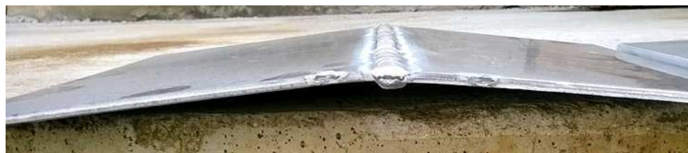
Obrázek 76 Slabé plechy s viditelnou deformací, vlastní zdroj
