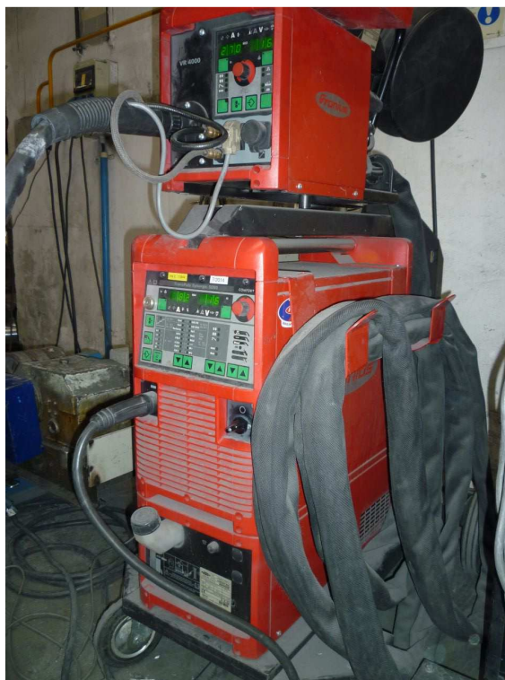
Obrázek 57 Svařovací digitální zdroj pro svařování hliníku a jeho slitin od firmy FRONIUS, typ TranPuls Synergic 5000, vlastní zdroj
