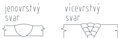
Obrázek 12 Jednovrstvý a vícevrstvý svar, převzato a upraveno z [7]
