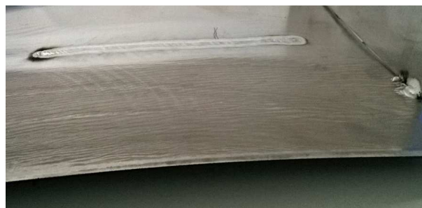
Obrázek 83 Plech vzorku s viditelnou deformací, vlastní zdroj
