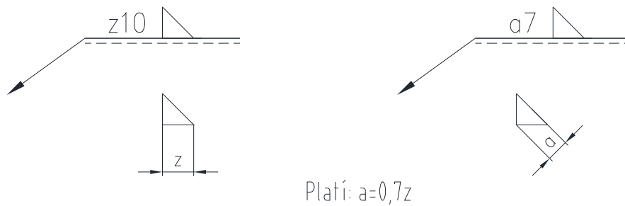
Obrázek 19 Příklady označení koutového svaru, převzato a upraveno z [4]
