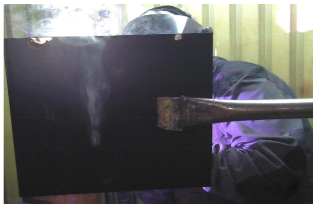
Obrázek 82 Poloha svařování a upnutí plechu v polohovadle, vlastní zdroj
