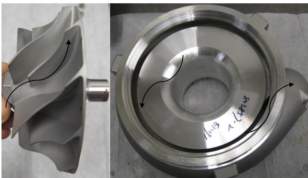
Obr. 6 Kompresorové koleso a skriňa turbodúchadla Garrett DL 36 [Honeywell]
