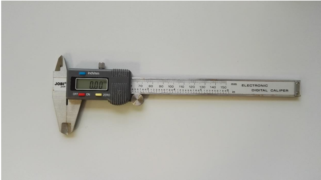
Obrázek č. 3: Elektronické posuvné měřidlo JOBI® profi (Autor DP, 2018)
