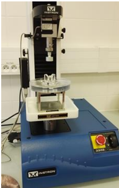
Obrázek č. 9: Přístroj Instron Universal Testing Machine (Autor DP, 2018)
