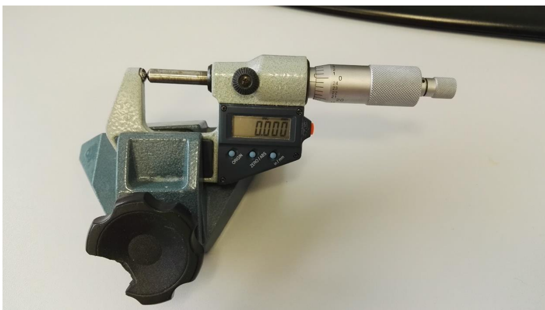
Obrázek č. 6: Digitální mikrometr Digimatic Outside Micrometer (Autor DP, 2018)
