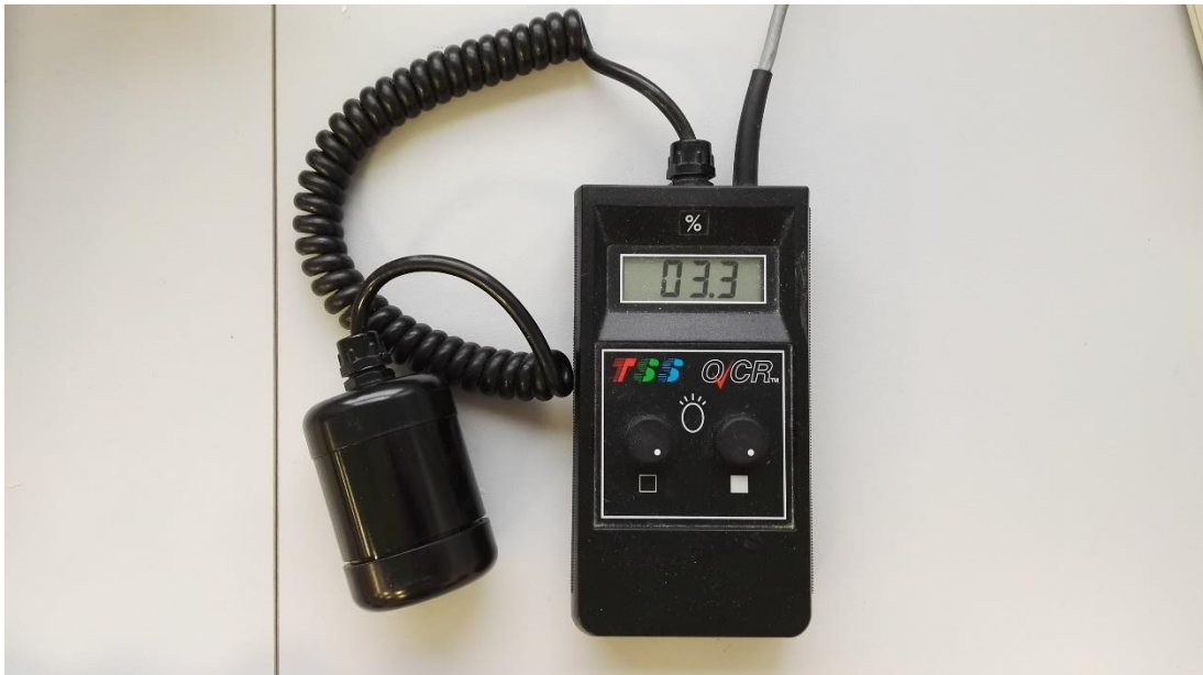
Obrázek č. 7: Reflektometr TSS QCR reflectometer (Autor DP, 2018)
