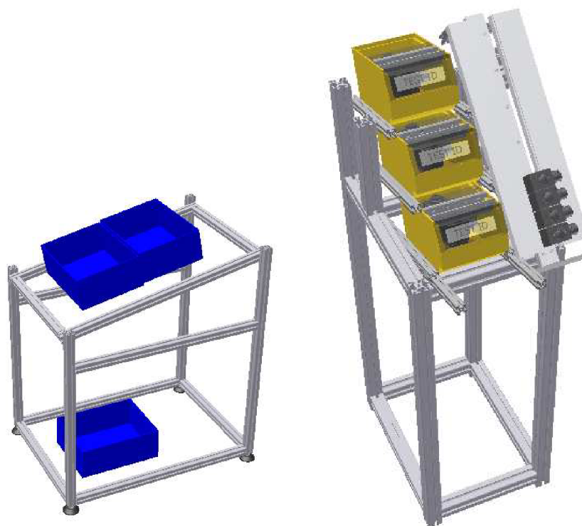
Obr. 18: Zásobník na polotovary a hotové kusy (vlevo) Zásobník na kusy, které neprošly výstupním testováním (vpravo)
