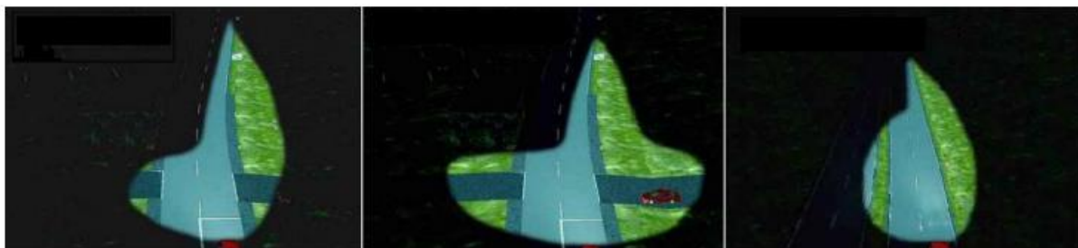
Obrázek 47 Adaptivní dynamické světlomety - různé jízdní režimy [28]
