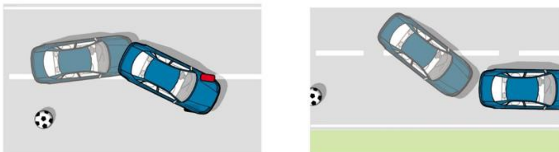
Obrázek 11 Zásah ESP řízeným přibrzdováním kol [22]
