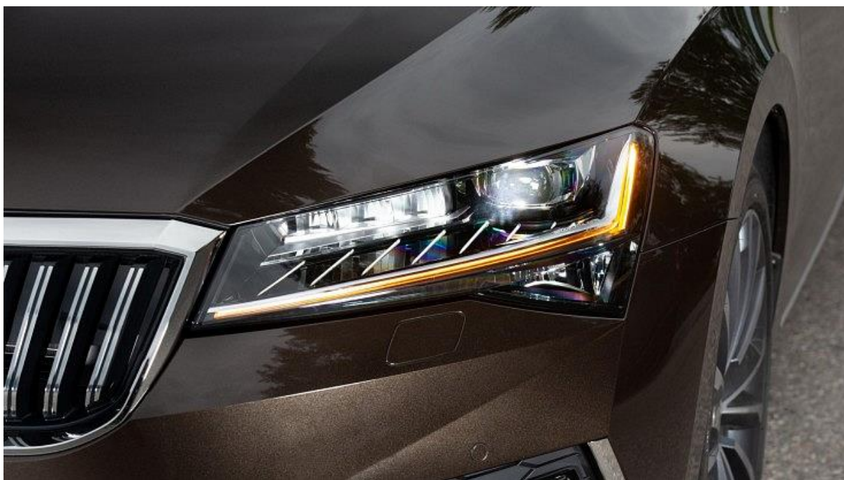
Obrázek 49 Světlomety s technologií LED MATRIX [27]
