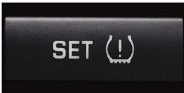
Obrázek 15 Kalibrace nepřímého systému TPMS [18]
