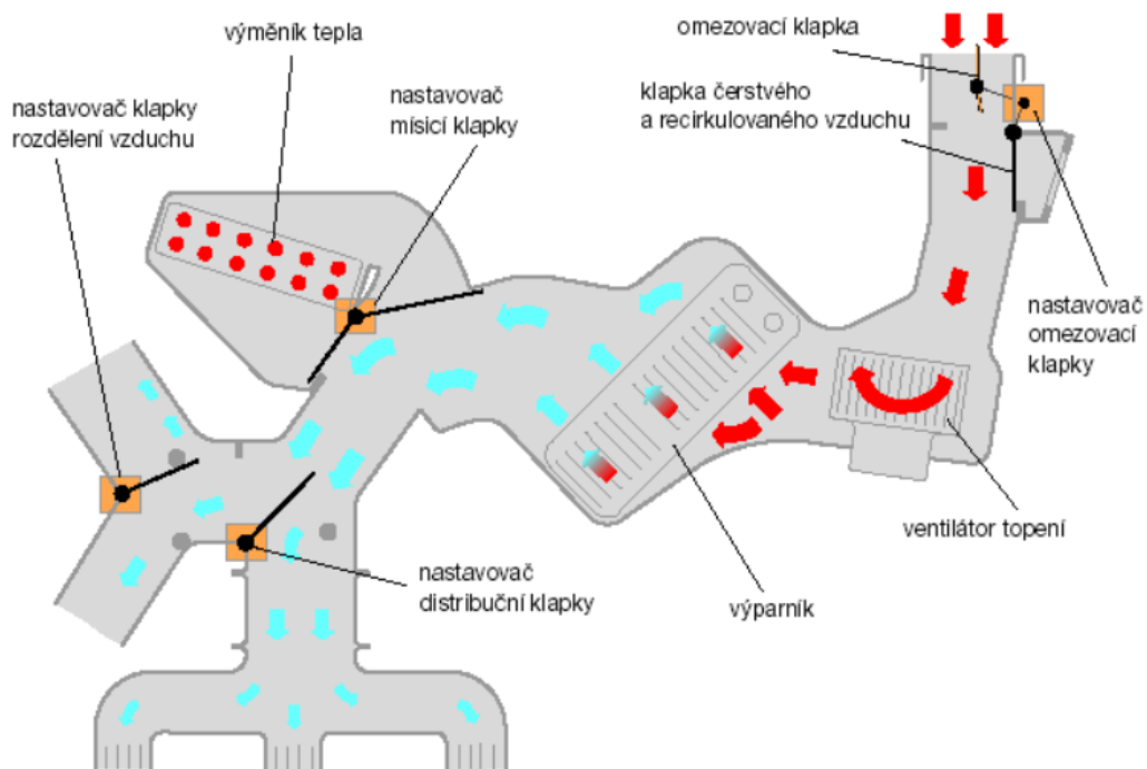
Obrázek 57 Schéma rozvodu vzduchu [25]
