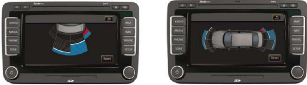
Obrázek 35 Zobrazení vzdálenosti při parkování [8]
