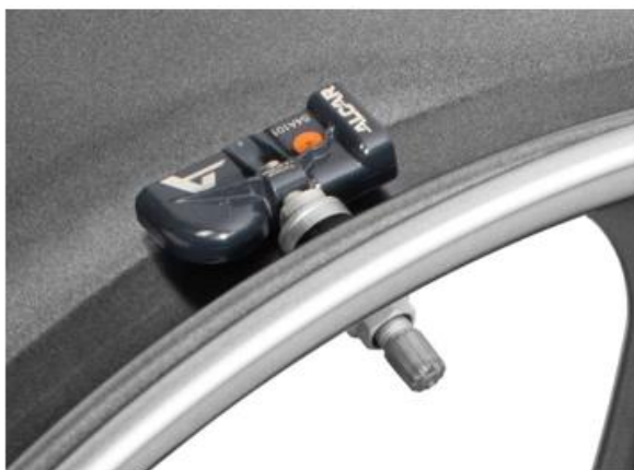
Obrázek 13 Přímý systém TPMS [17]
