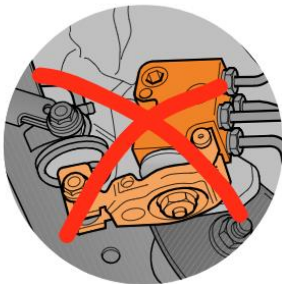
Obrázek 9 Zátěžový regulátor zadní nápravy [20]
