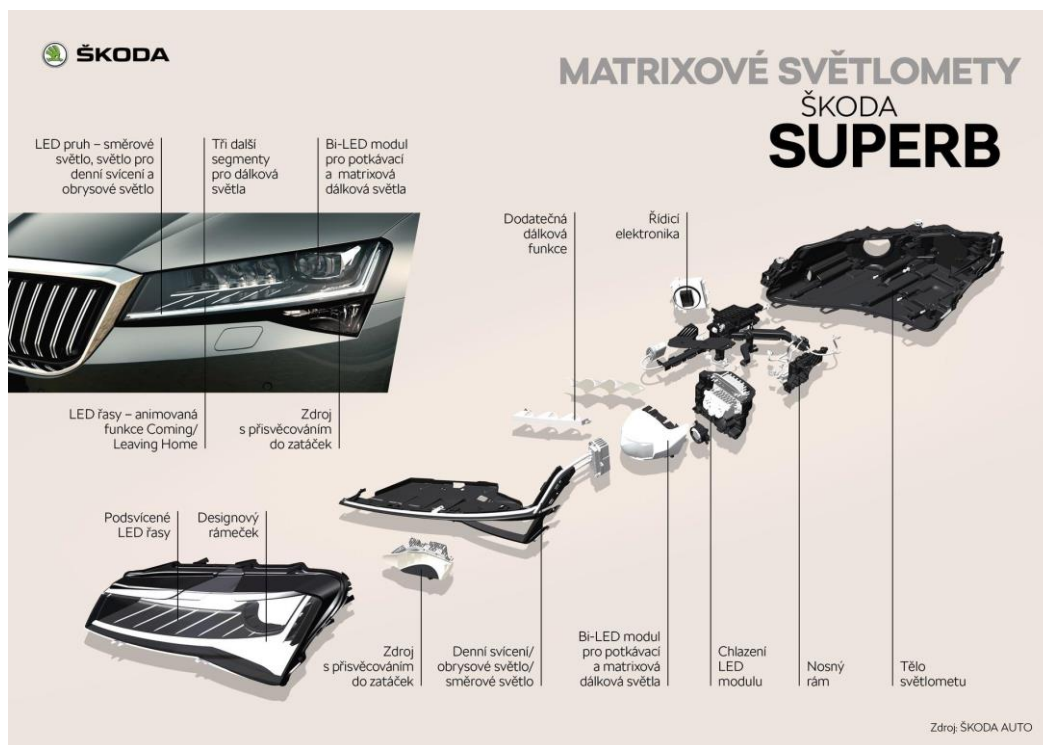
Obrázek 51 Hlavní části světlometu LED MATRIX [28]
