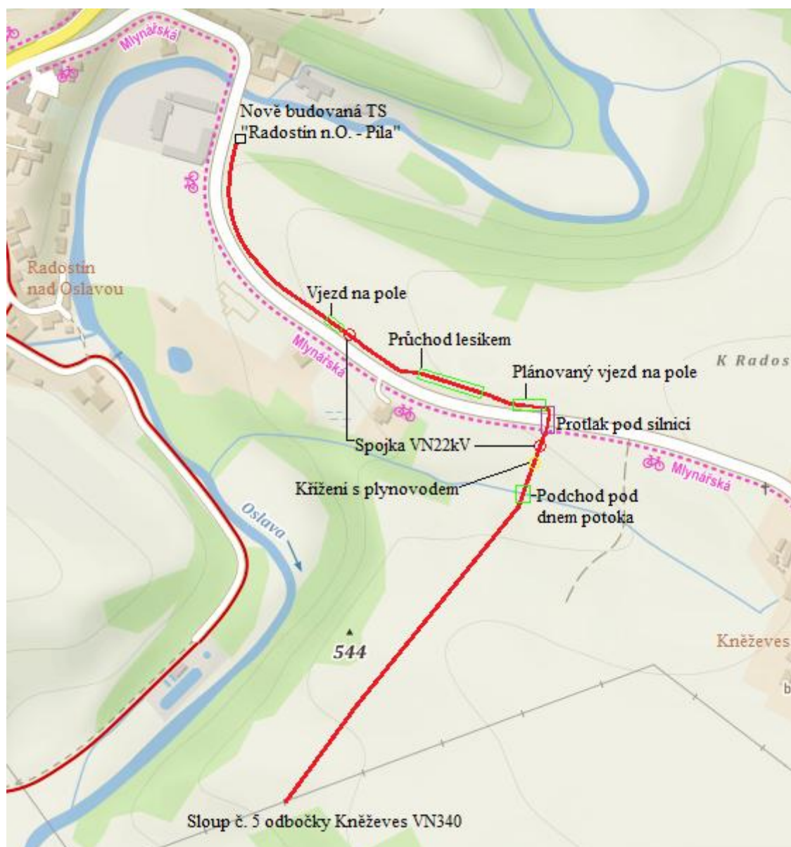
Obrázek 7-6 Náčrt měřené kabelové trasy
