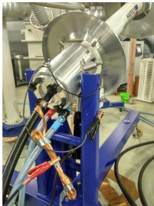
Obrázek 8-7 Zapojení nízkonapěťové větve můstku
