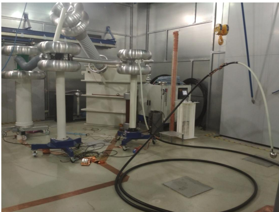
Obrázek 8-2 Zapojení měření příčných parametrů
