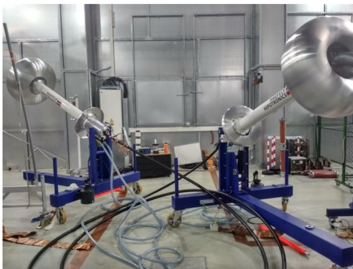
Obrázek 8-5 Připojení konců kabelu do vodních koncovek
