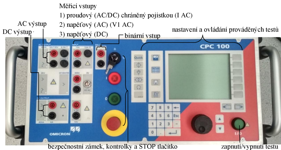
Obrázek 7-1 Jednotka CPC 100 - přední panel
