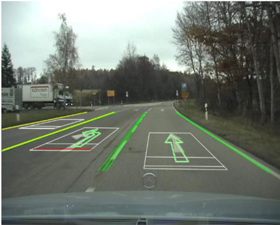
Obr. 15 Analýza vodorovného dopravního značení pro autonomní vozidlo [22]
