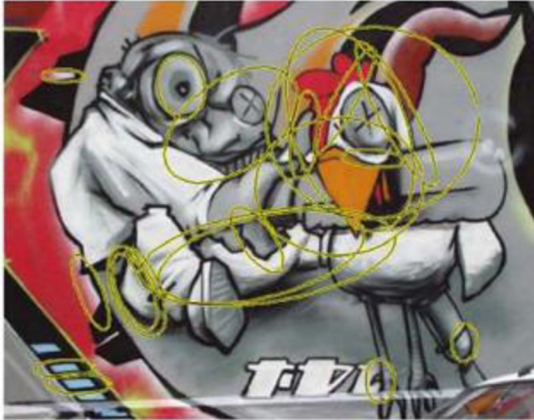
Obr. 12 Ukázka výstupu MSER detektoru. Nalevo jsou zobrazeny nalezené regiony. Napravo je detail elips nalezených MSER regionů [21]
