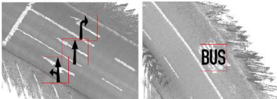
Obr. 16 Systém lokalizující vodorovné značení pomocí OCR [23]
