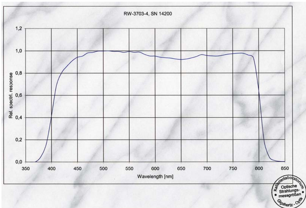
Obr. 38 Spektrálna odozva rádiometra X97 Irradiance Meter so sondou X9-7.
