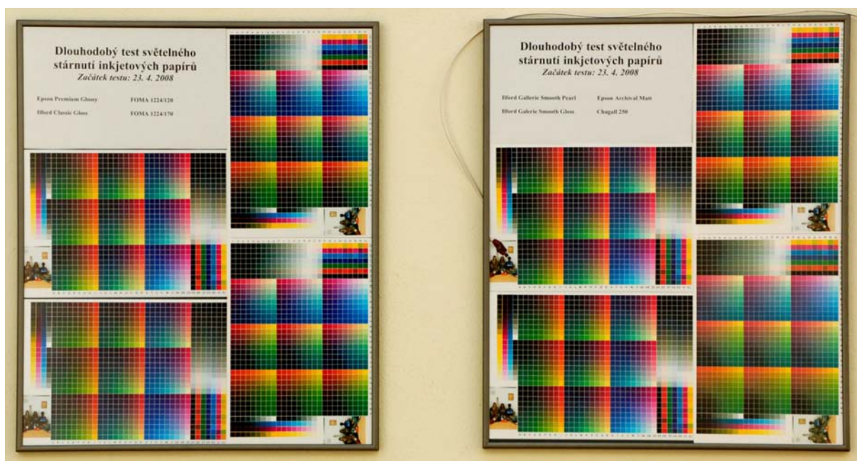
Obr. 27 Testovacie škály v rámoch umiestnených na stene slnečnej chodby spolu s fotocitlivým senzorom intenzity ožiarenia.
