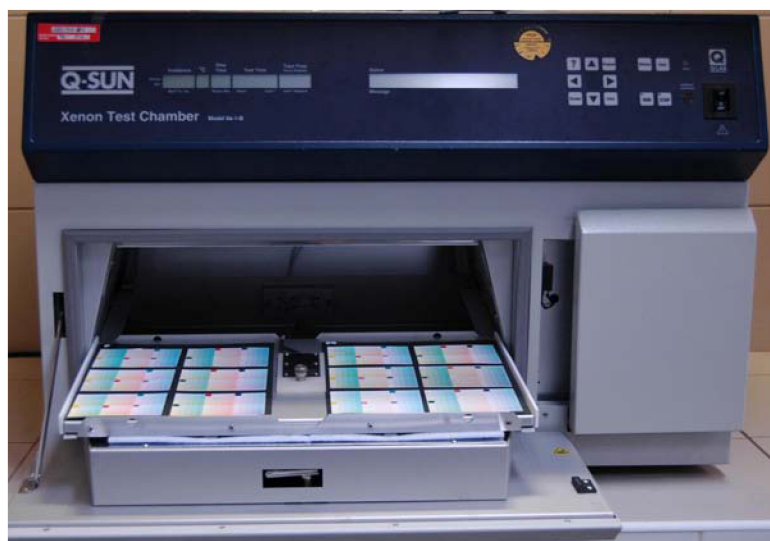
Obr. 34 Q-SUN Xenon Test Chamber, Model Xe-1-B/S so vzorkami.
