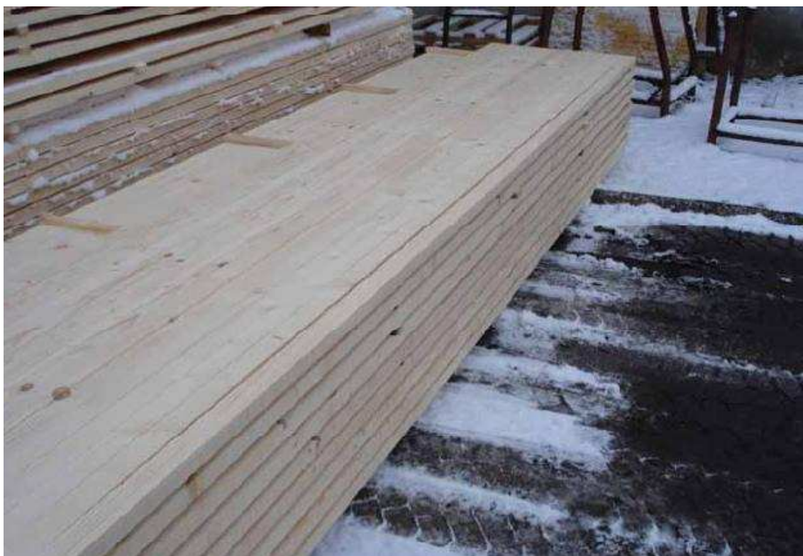
Obr. č. 24 – Řezivo z rozbalené hráně
