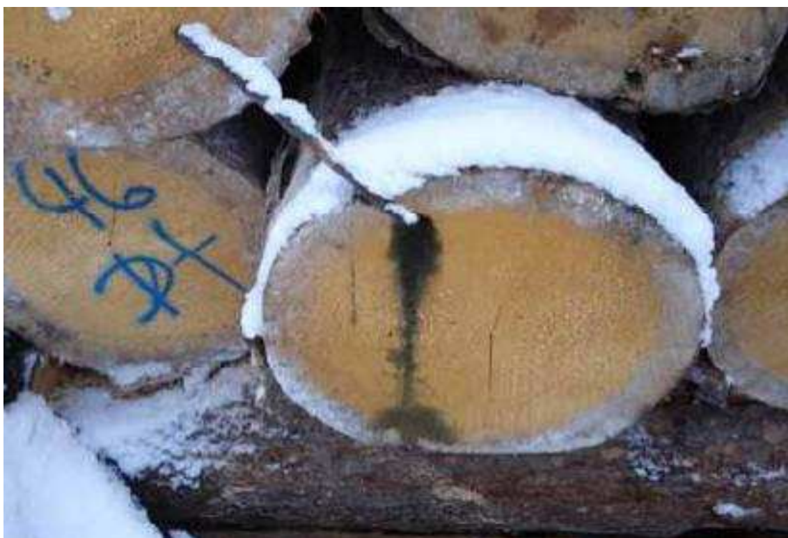
Obr. č. 22 – Kondenzát stékající z kramle, jde pouze o povrchové zabarvení dřeva. Vše bílé není plíseň - sníh
