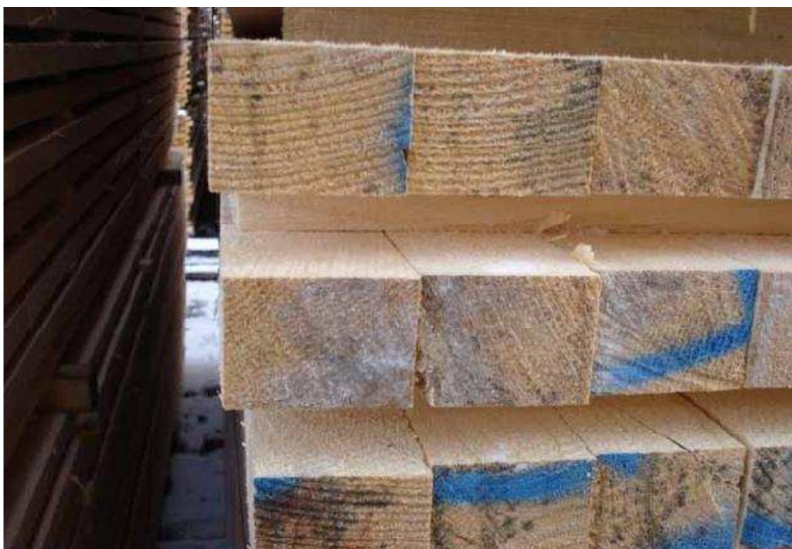
Obr. č. 26 – Povrchové zabarvení čel plísni
