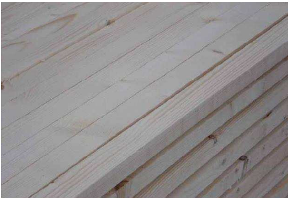
Obr. č. 23 – Řezivo z kulatiny z rozbalené hráně po 8 měsících
