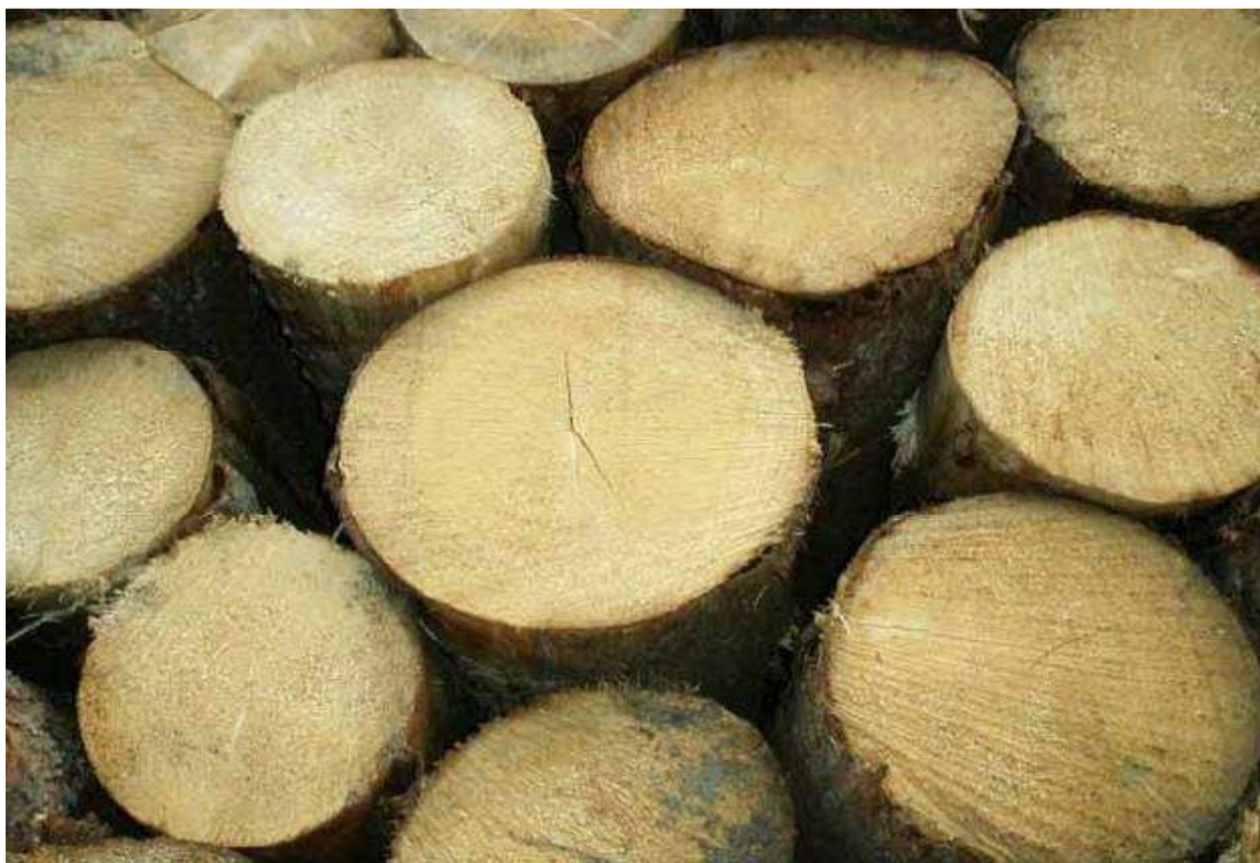
Obr. č. 20 – Detail dřeva po rozbalení po 8 měsících
