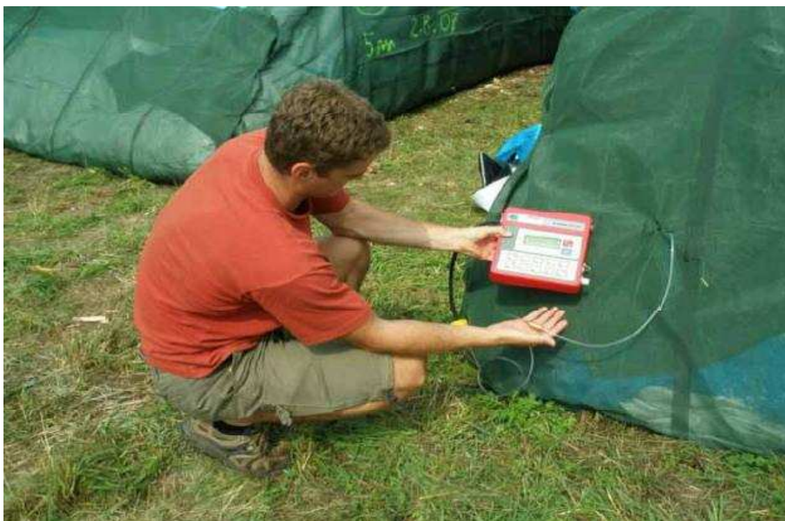
Obr. č. 18 – Praktická ukázka měření obsahu CO 2 a O 2 v zabalené hráni
