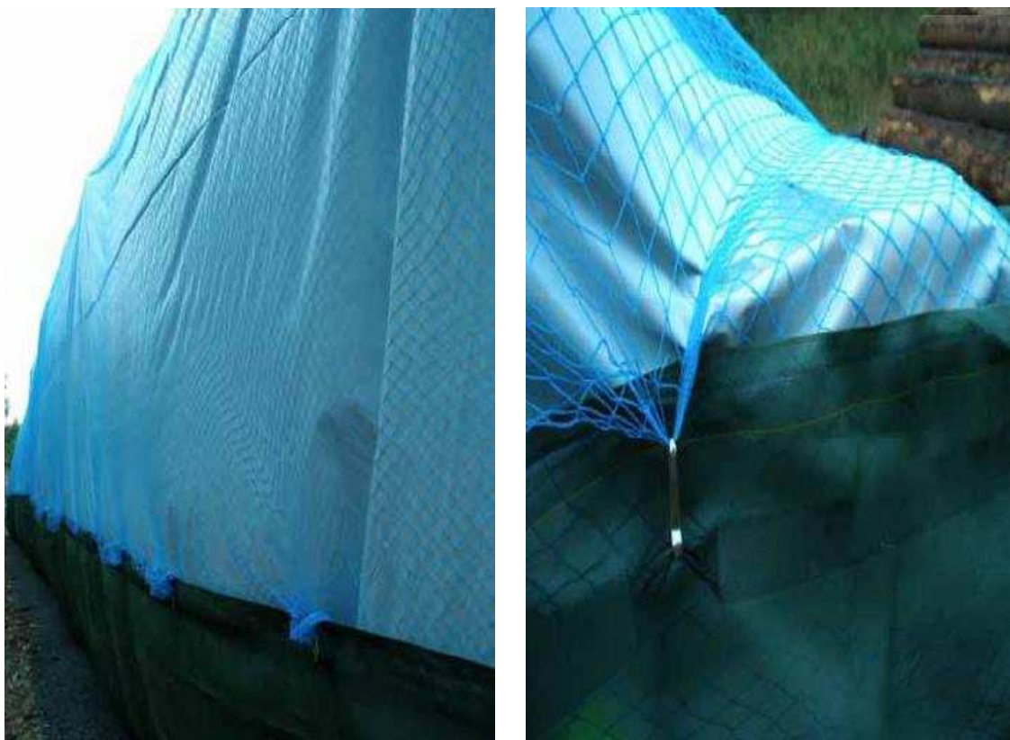
Obr. č. 13, 14 – Spojení spodní ochranné sítě s vrchní nylonovou sítí
