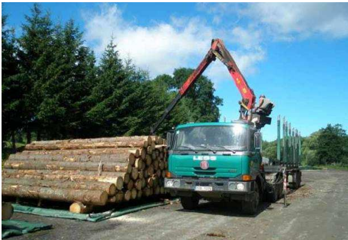
Obr. č. 3 – Rovnání hrání pomocí odvozní soupravy
