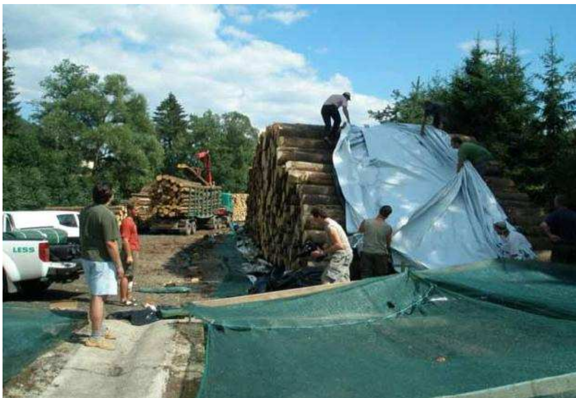
Obr. č. 9 – Roztahování fólie přes celou šířku hráně
