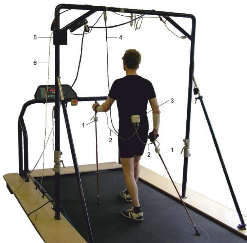
Obrázek 5. Systém MPAF (System for Monitoring of the Pole Axial Force in Nordic Walking) (Krejčí, Jakubec, Pšurný, & Janura, 2013)
