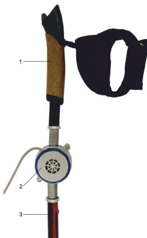
Obrázek 6. Jednoosý tenzometr vložený do hole (Krejčí et al., 2013)
