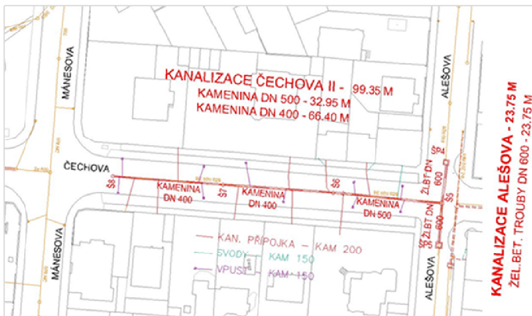
obr. č. 5 - Kanalizace Čechova II
