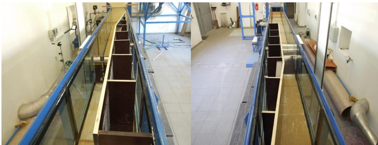
Obr. 7 Pohled na instalaci modelu v pohyblivém žlabu o šířce 412 mm, prostor měření byl pomocí překližky zúžen na šířku 201 mm, tak aby byla splněna podmínka ve vztahu (4.2).
