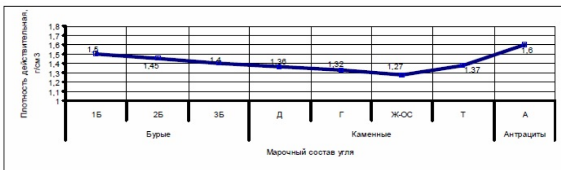
Рисунок 5 -.Кажущаяся плотность углей разных марок.
