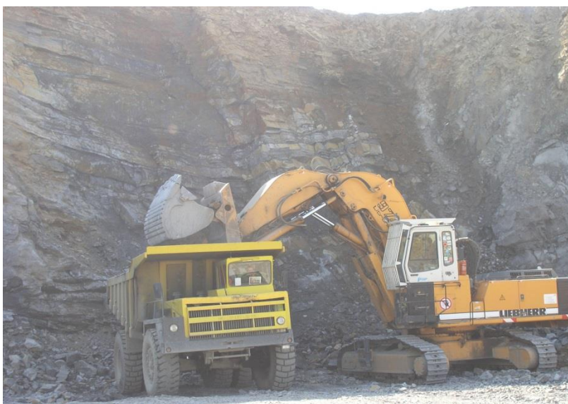
Obr. 18 Nakládka rozvalu - pásové rypadlo a dempr, kamenolom Bohučovice [14]
