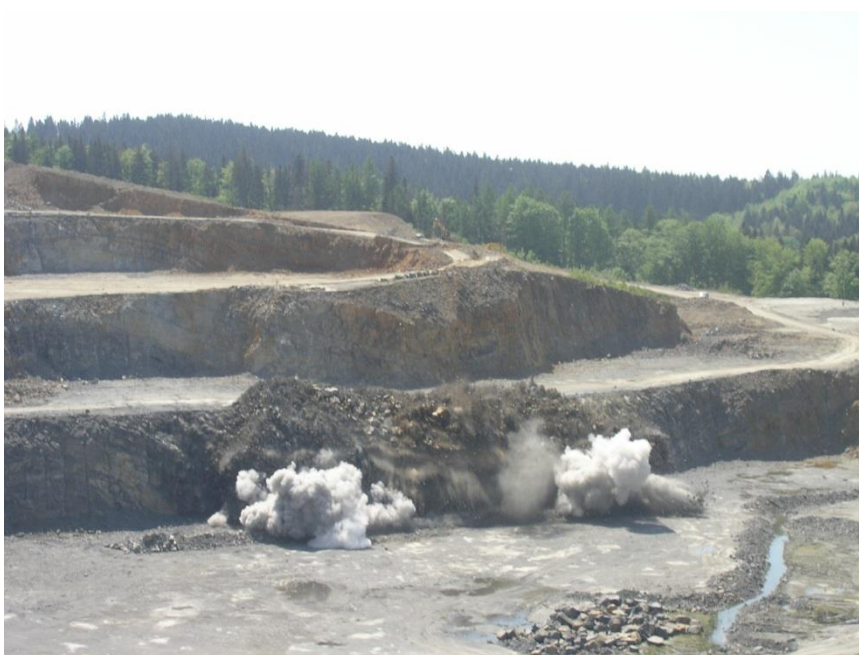
Obr. 17 Clonový odstřel v kamenolomu Bohučovice [14]
