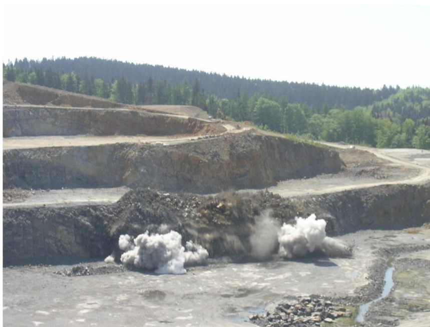
Obr. 17 Clonový odstřel v kamenolomu Bohučovice [14]
