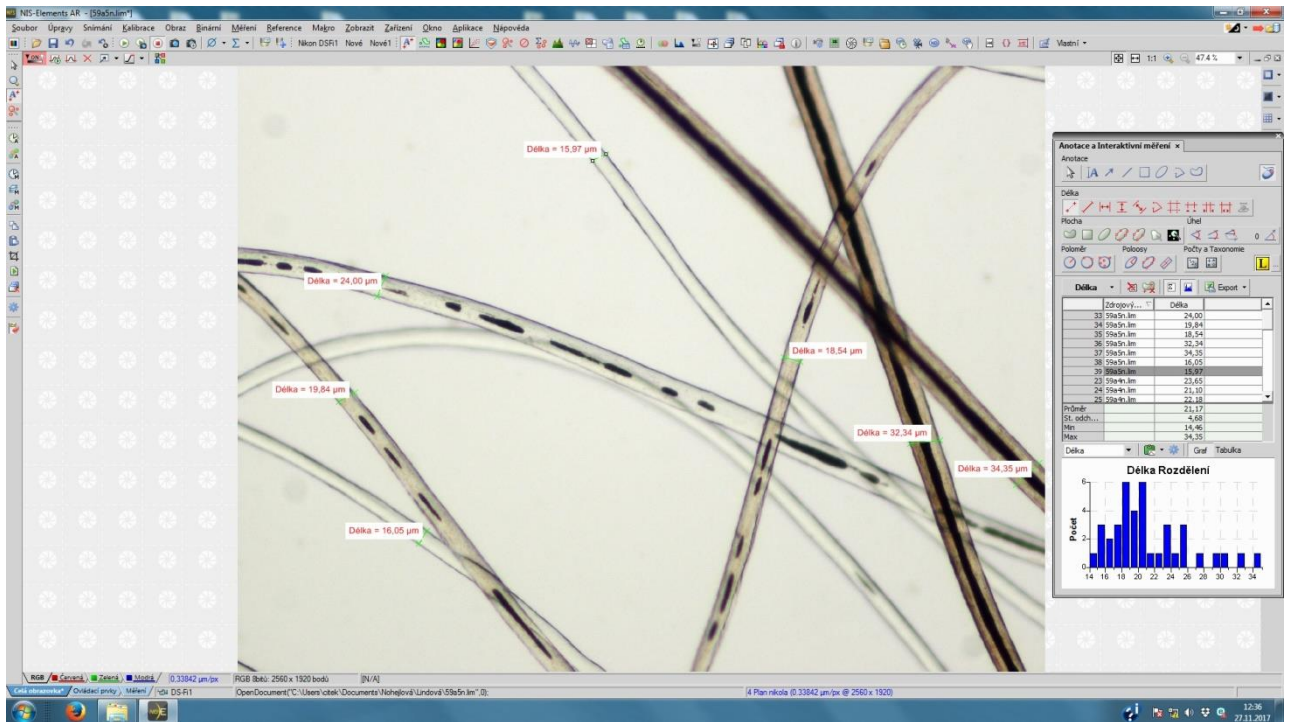
Příloha č. 26 Měření jemnost vláken v programu NIS – Elements AR TM 3.10 (vlastní zdroj, 2017)
