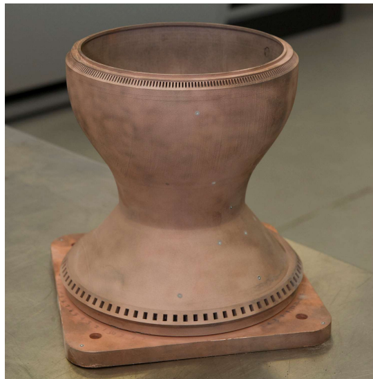
Obrázek 1.0: 3D tisknutá tryska s vnitřními chladícími kanálky [11].
