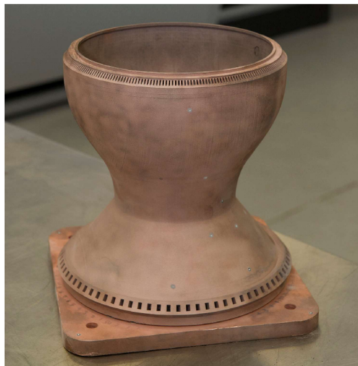
Obrázek 1.0: 3D tisknutá tryska s vnitřními chladicími kanálky [11].
