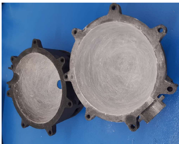
Obrázek 3.10: Tmelení kulového integrátoru.
