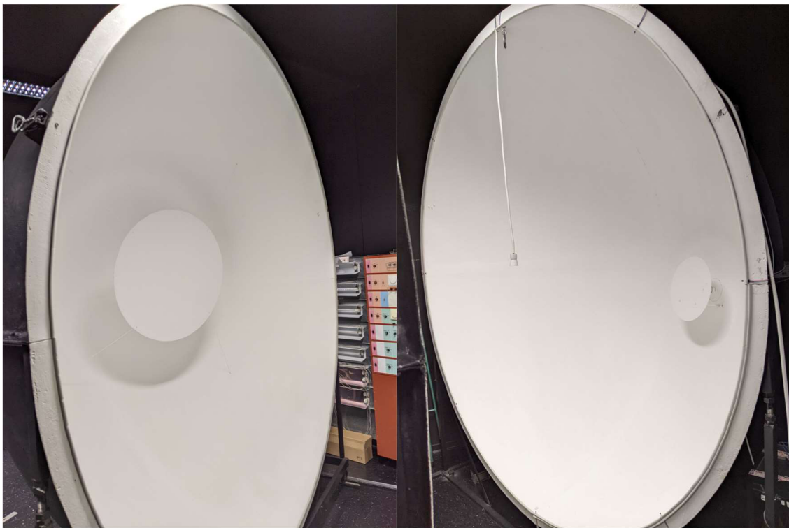
Obr. 21: Fotodokumentace – levá, pohyblivá, polokoule s hlavní clonou a pravá, nepohyblivá polokoule s vedlejší clonou kulového integrátoru
