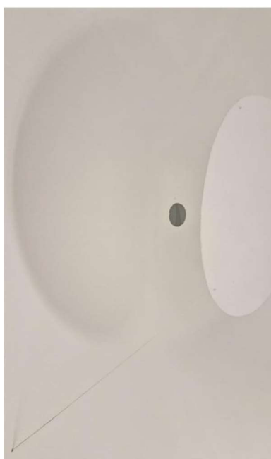
Obr. 31: Otvor pro detektor spektrometru krytý plexisklem
