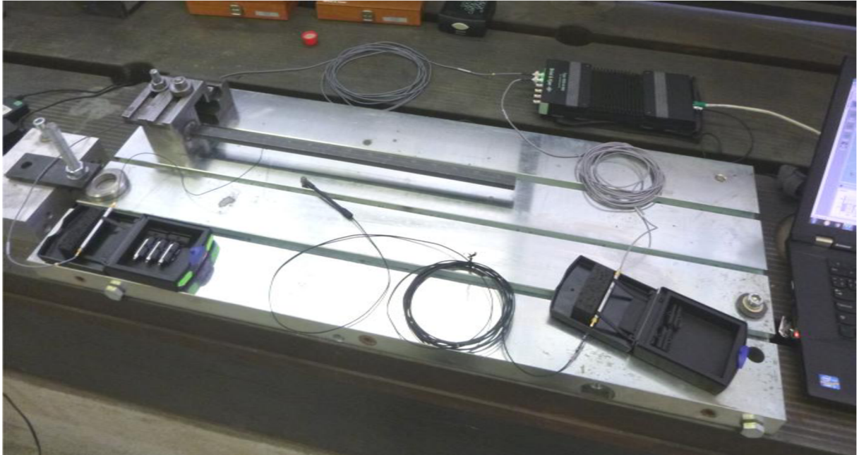
Obrázek 8.1 Pohled na experimentální modální analýzu vybrané součásti.
