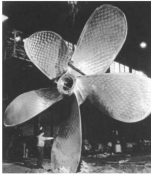
Obrázek 4: Lodní šroub odlitý z hliníkového bronzu s příměsí niklu [6]
