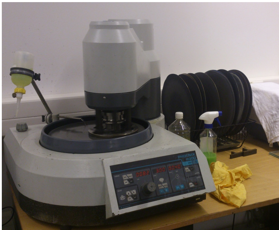
Obrázek 17: Strojní broušení vzorků strojem Phoenix 4000
