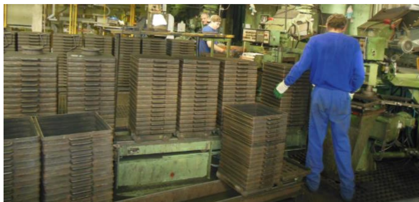
Obr. 3.3 Pohled na formovací stroj pro výrobu forem, vpravo, v popředí jsou formovací rámy naskládáné nad sebou, v pozadí jsou formy naskládáné do etáže
