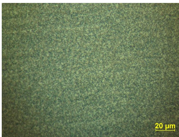
Obr. 3.23 Mikrostruktura pístního kroužku, ocel – Nitral, zvětšení 500násobné (10x50), kroužek č. 2
