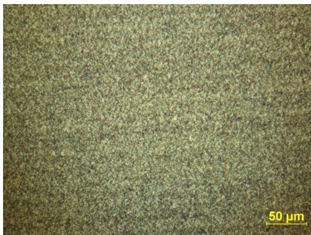
Obr. 3.22 Mikrostruktura pístního kroužku, ocel – Nitral, zvětšení 250násobné (20x12.5), kroužek č. 2
