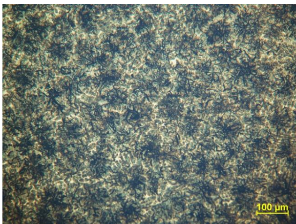
Obr. 3.16 Mikrostruktura pístního kroužku z litiny s lupínkovým grafitem – Nital, zvětšení 100násobné (8x12,5), kroužek č. 1
