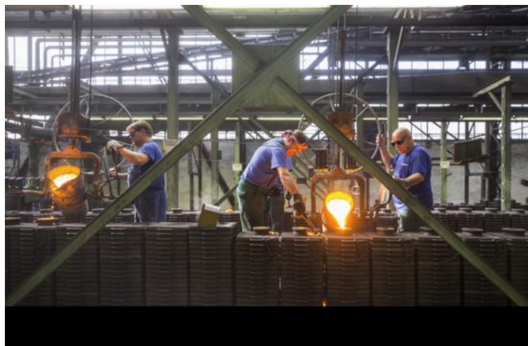
Obr. 3.8 Odlévání etážových forem při odlévání litinových polotovarů pístních kroužků
