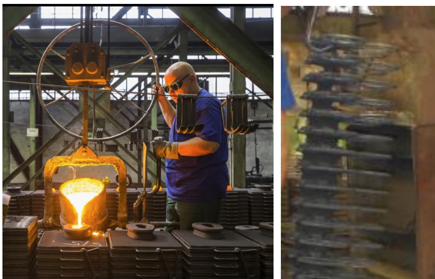
Obr. 3.10 Pohled na odlévání etážových forem při výrobě litinových pístních kroužků (vlevo) a ukázka odlitého stromečku pístních kroužků z etážových forem (vpravo)
