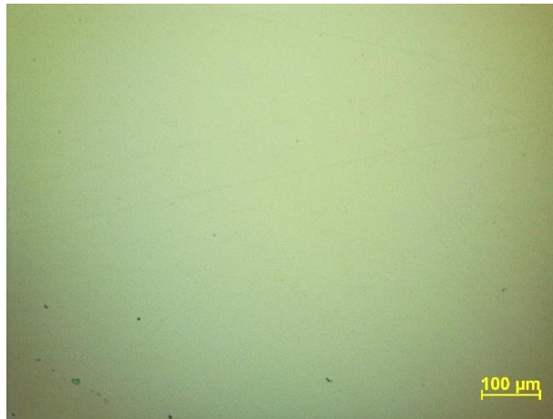
Obr. 3.20 Mikroštruktúra pístního kroužku, ocel – neleptáno, zvětšení 100násobné (8x12,5), kroužek č. 2
