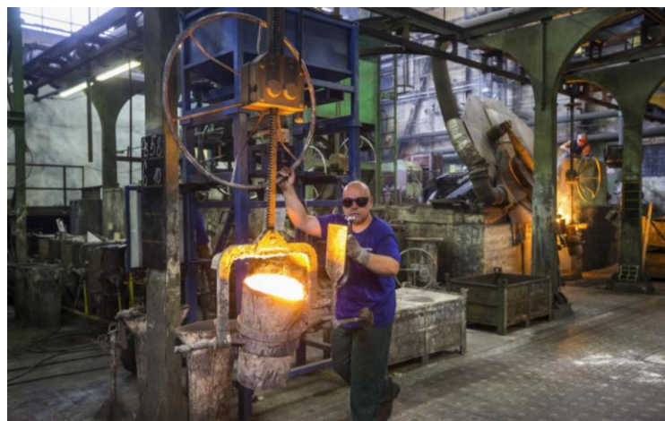
Obr. 3.9 Pohled do tavírny na elektrické indukční pece
