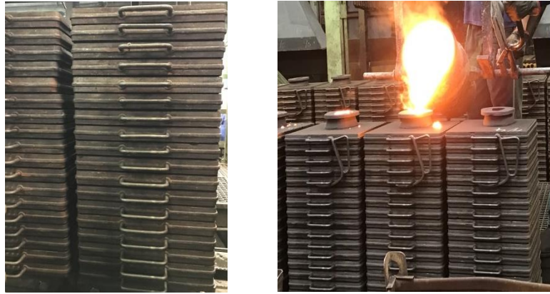
Obr. 3.7 Formy pro etážové lití a odlévání do forem pro etážové lití
