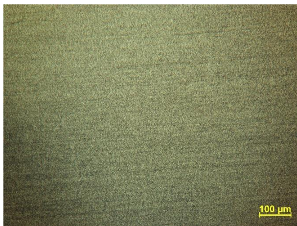
Obr. 3.21 Mikroštruktúra pístního kroužku, ocel – Nital, zvětšení 100násobné (8x12,5), kroužek č. 2
