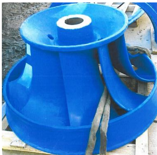
Obr. 4.7 Foto repasované Francisovy turbíny [vlastní zdroj]
