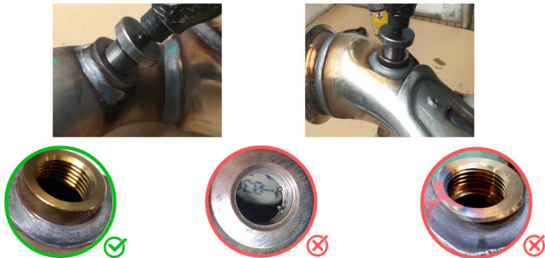
Obr. 14 Kontrola závitu kroužků
