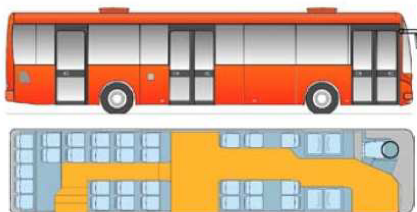
Obrázek 12 Autobus Crossway Low Entry - rozmístění sedadel [6]
