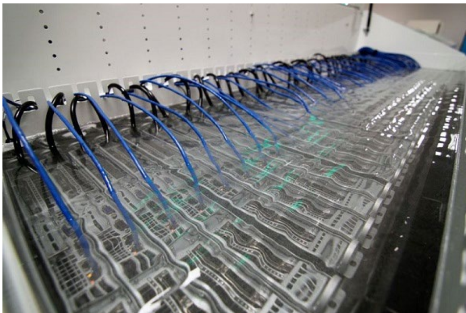
Obr 11 Ukázka ponorné chlazení
