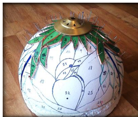
Obr. 17: Špendlení skla na polystyrenovou formu (foto: Hořáková Petra)
