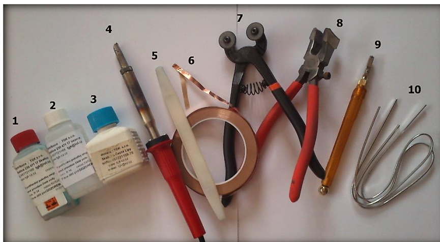
Obr. 19: Nástroje a pomůcky k výrobě vitráží technikou Tiffany (foto: Hořáková Petra)
