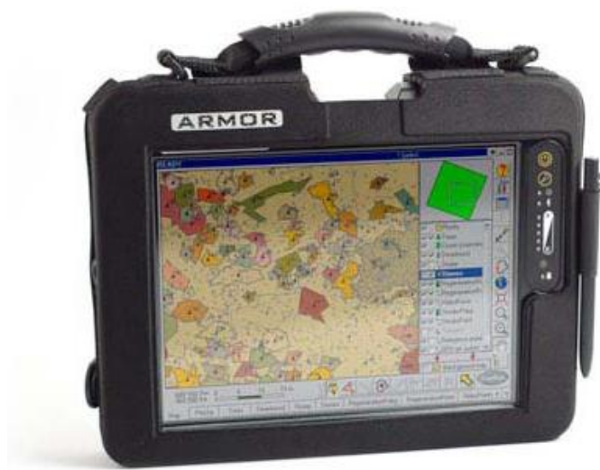
Obrázek 6: Terénní počítač s nainstalovaným Field-Map software
