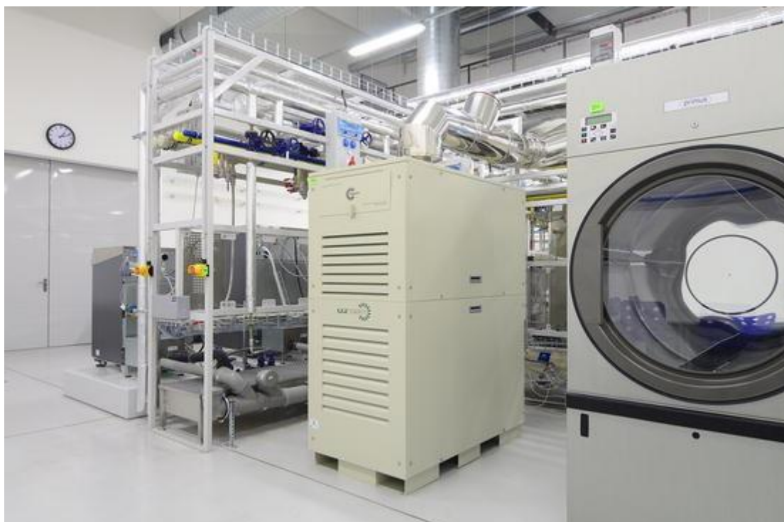
Obr.12 Mikroturbína Capstone C30 v Laboratóriu energeticky náročných procesov v NETME centre [23]
