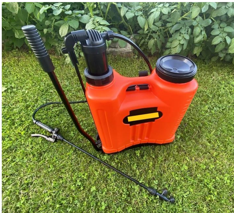
Obr. 5 Ukázka velkého tlakového postřikovače (princip fungování se nemění v rámci různých výrobců, proto je logo výrobce zamazáno). © Kostkan
