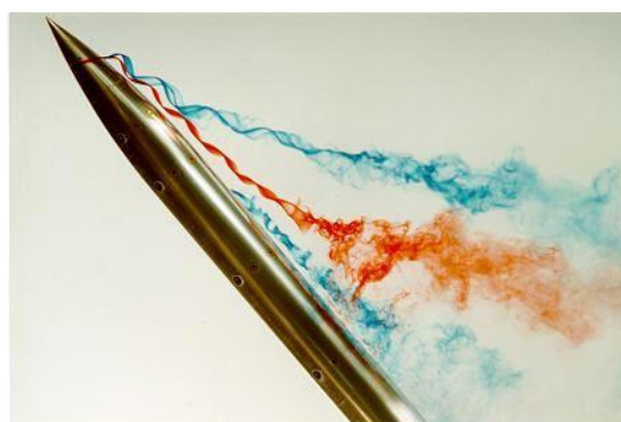
Obr. 5.1 Vizualizácia streaklines pomocou farbiva vo vode [29]
