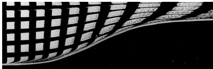
Obr. 8.3 Predĺženie kombinovaných markerov po zúžení prierezu indikuje nárast lokálnej rýchlosti prúdenia [4]
