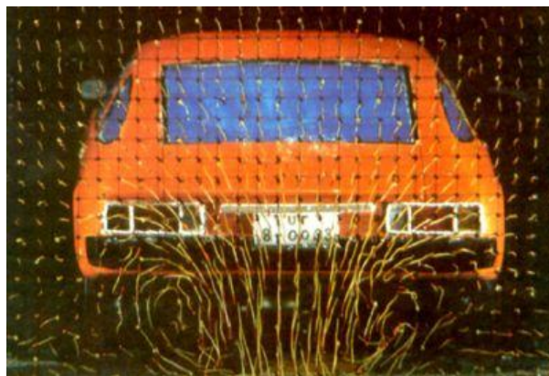
Obr. 7.1 Zviditeľnenie prúdenia za osobným automobilom pomocou mriežky s niťovými sondami [20]
