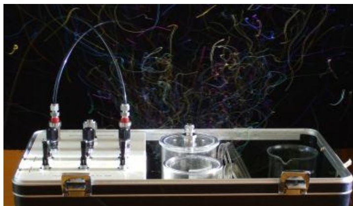
Obr. 12.2 Skúška generátora bublín bez krytu cyklónovej komory
