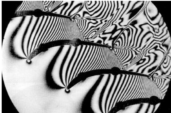
Obr. 9.7 Interferogram obtekania lopatkovej mreže turbíny pri výstupnej rýchlosti vzduchu 445 m/s [20]
